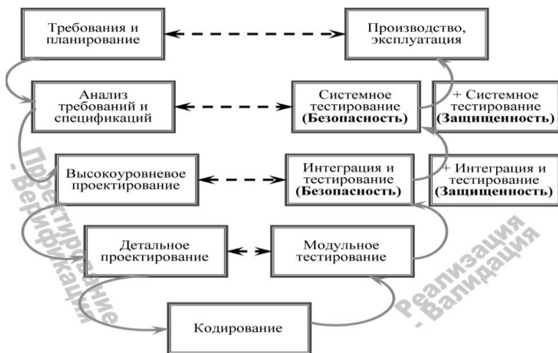
Рисунок 2 – Расширенная V-образная модель жизненного цикла программного обеспечения для обеспечения качества программного обеспечения
