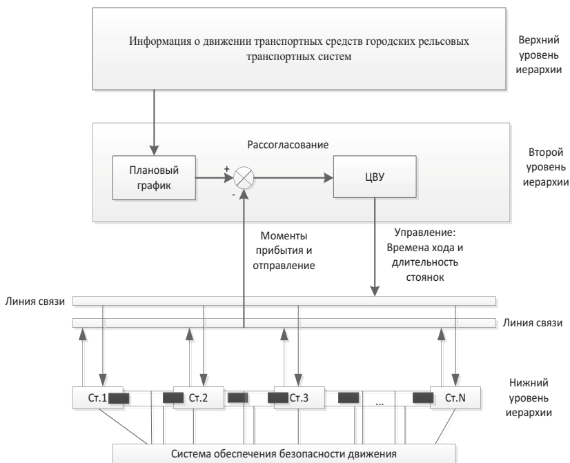
Рисунок 1 – Структура Интеллектуальной системы управления движением внеуличным транспортом
